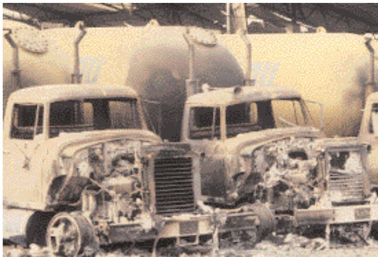
*A 300 m du lieu initial des BLEVES, des dizaines de camions sont remplis de gaz, près à la livraison. L'onde de chaleur détruit la partie moteur des véhicules ; par bonheur, les citernes résistent. Immédiatement à côté, des centaines de bouteilles de gaz chargées sur d'autres camions ne résisteront pas : nouvelles projections de missiles dans toutes les directions jusqu'à 2 km*
